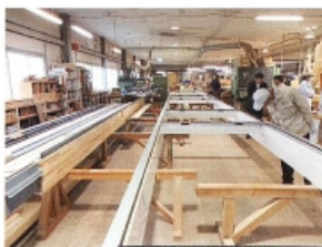
木・アルミ複合サッシ組立状況
