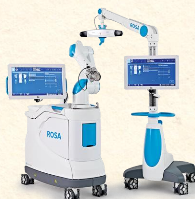
図4. 人工ひざ関節手術支援ロボットシステム
